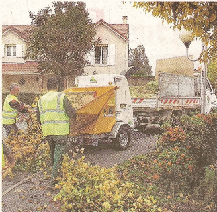
MORANGIS, SAMEDI DERNIER. Les employés des services techniques de la ville passent dans le broyeur accroché derrière leur camion les branches déposées par des particuliers. Cela évite aux habitants de se déplacer à la déchetterie.
